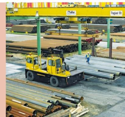
**Bild 3:** Der Staplerkapitän ist im Außenlager auf die Hilfe des so genannten Rohrverladers angewiesen; Mannesmann Fuchs Rohr hat die Jumbo-Seitenstapler deshalb mit einer zweiten Kabine versehen lassen
